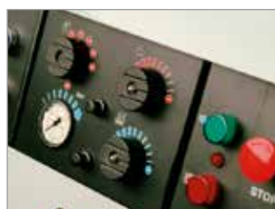
PANEL DE CONTROL CON APAGADO DE EMERGENCIA
